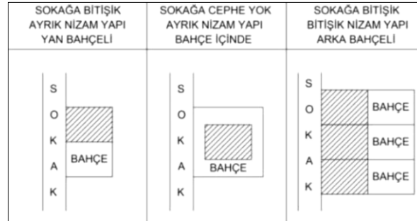
Şekil 3. Tekirdağ'daki Geleneksel Konutların Sokak, Yapı ve Bahçe İlişkisi (Şık, 2013: 22)
